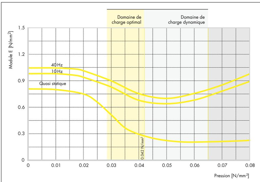
Le relevé du module d'élasticité dynamique de l'APSOPUR® L42 sous excitation sinusoïdale à charge médiane constante, et une amplitude de  $\pm 0,25$  mm.
