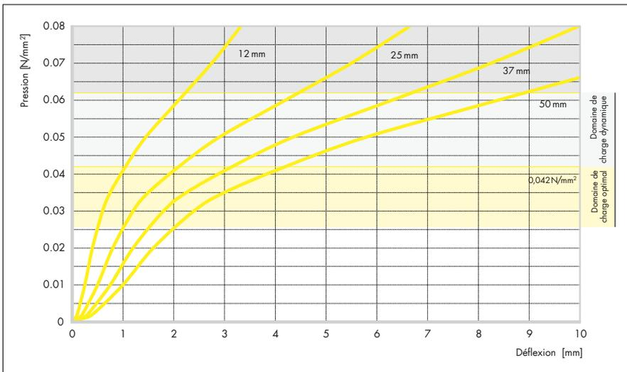
Contrôle de la déflexion de l'APSOPUR® L42 entre deux plaques de charge plates, suivant DIN EN 826.
