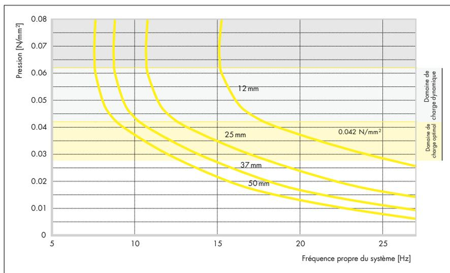
Fréquences propres d'un système vibratoire à un degré de liberté, comprenant une masse rigide et un appui élastique en APSOPUR® L42 sur structure rigide.
