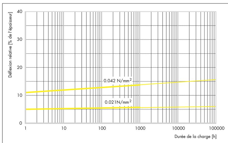
Augmentation de la déformation sous pression constante de l'APSOPUR® L42.
