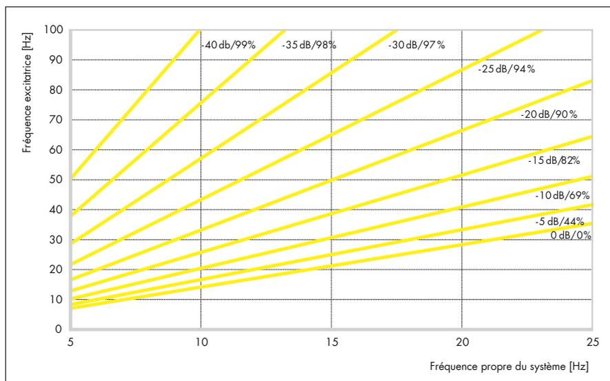
Représentation de la réduction de la transmission des vibrations mécaniques avec de l'APSOPUR® L42 sur structure rigide. Paramètres: niveau de transmission en dB, et efficacité de l'isolation vibratoire en %.
