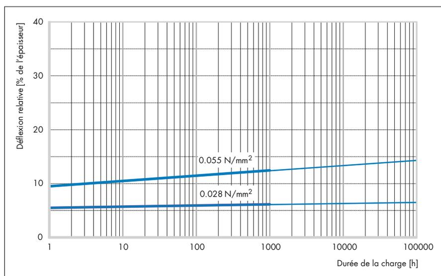
Augmentation de la déformation sous pression constante de l'APSOPUR® L55.
