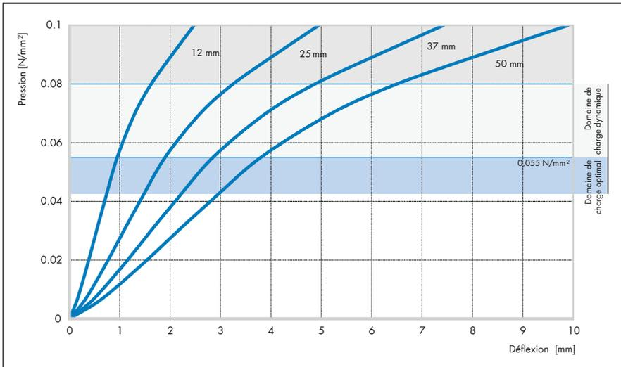
Contrôle de la déflexion de l'APSOPUR® L55 entre deux plaques de charge plates, suivant DIN EN 826.
