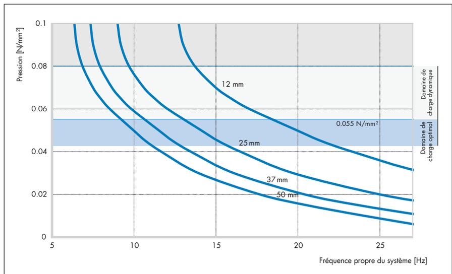
Fréquences propres d'un système vibratoire à un degré de liberté, comprenant une masse rigide et un appui élastique en APSOPUR® L55 sur structure rigide.
