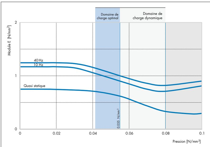
Le relevé du module d'élasticité dynamique de l'APSOPUR® L55 sous excitation sinusoïdale à charge médiane constante, et une amplitude de  $\pm 0,25$  mm.
