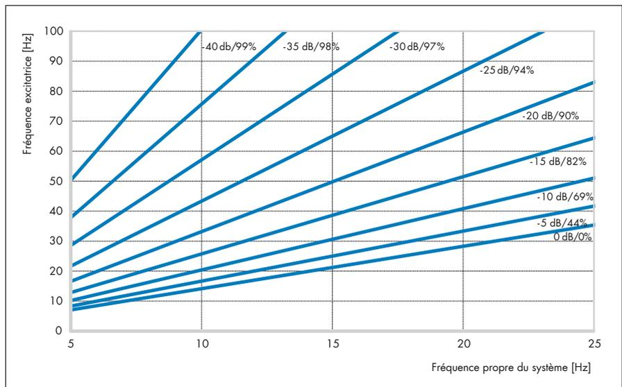
Représentation de la réduction de la transmission des vibrations mécaniques avec de l'APSOPUR® L55 sur structure rigide. Paramètres: niveau de transmission en dB, et efficacité de l'isolation vibratoire en %.
