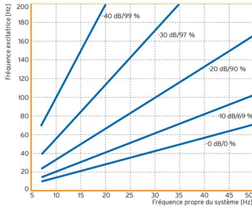
Réduction de la transmission des vibrations mécaniques à l'aide d'un appui élastique en Sylodyn® NE sur une structure rigide.
