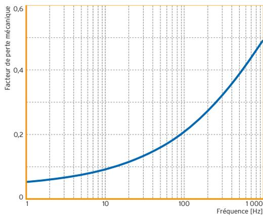
Essais DMA ; courbe référentielle sous température de référence à 21 °C ; mesures effectuées sous faible pression dans la zone linéaire de la courbe de déflexion
