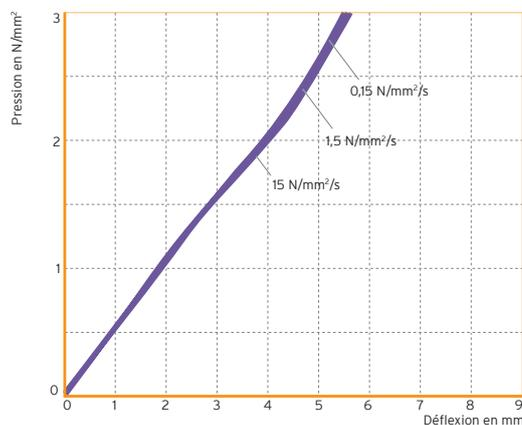
**Influence de l'amplitude :** Précontrainte sous charge statique permanente ; facteur de forme :  $q = 3$  ; épaisseur du matériau : 25 mm
