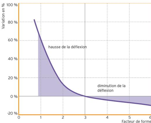
**Influence du facteur de forme sur la valeur limite de la charge statique permanente pour un matériau homogène**
