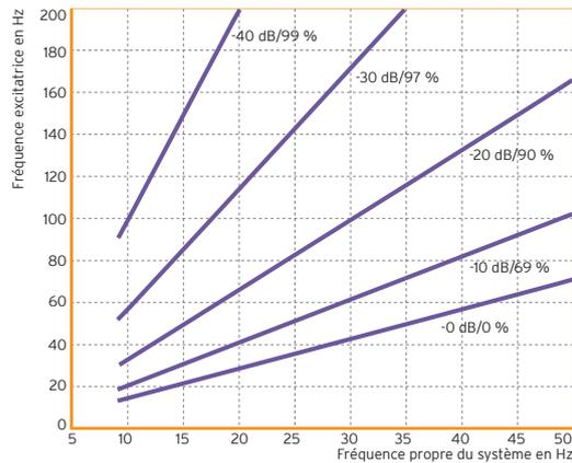
Réduction de la transmission des vibrations mécaniques à l'aide d'un appui élastique en Sylodyn® NF sur une structure rigide.
