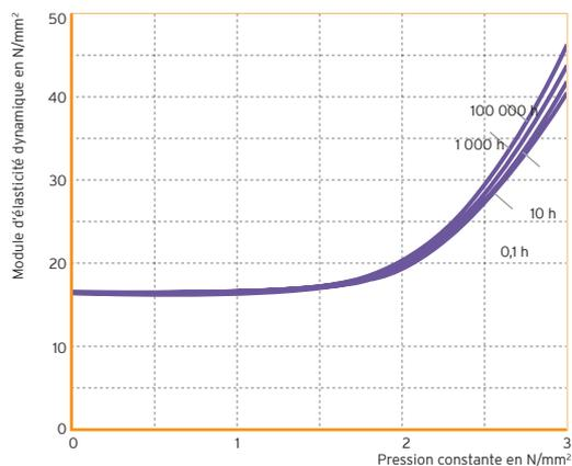
Modification du module d'élasticité dynamique sous charge constante (10 Hz)
