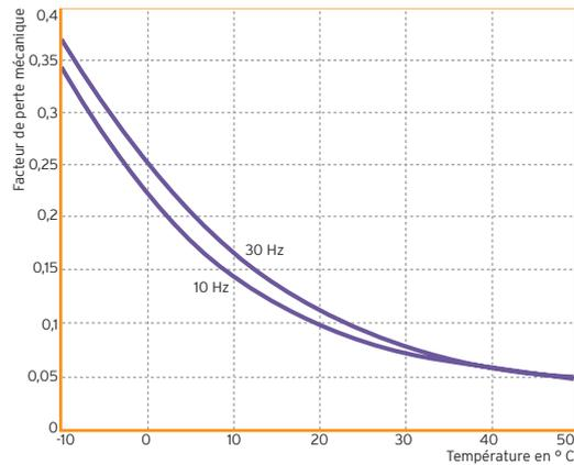
Essais DMA (analyse dynamique mécanique) ; mesures effectuées sous faible pression dans la zone linéaire de la courbe de déflexion
