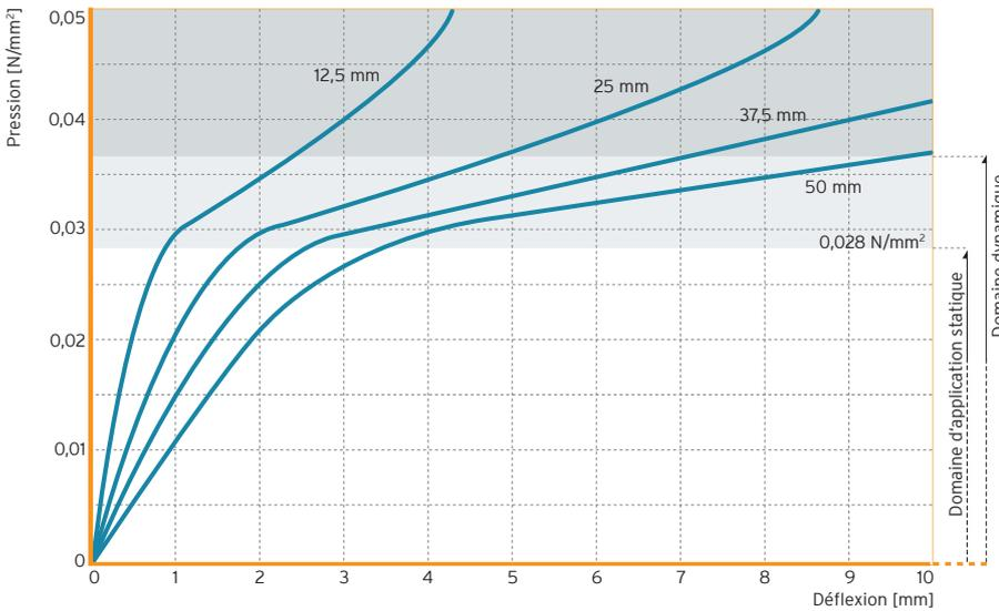
Figure 1 : Courbe de déflexion quasi-statique avec une vitesse de charge de 0,0028 N/mm<sup>2</sup>/s
